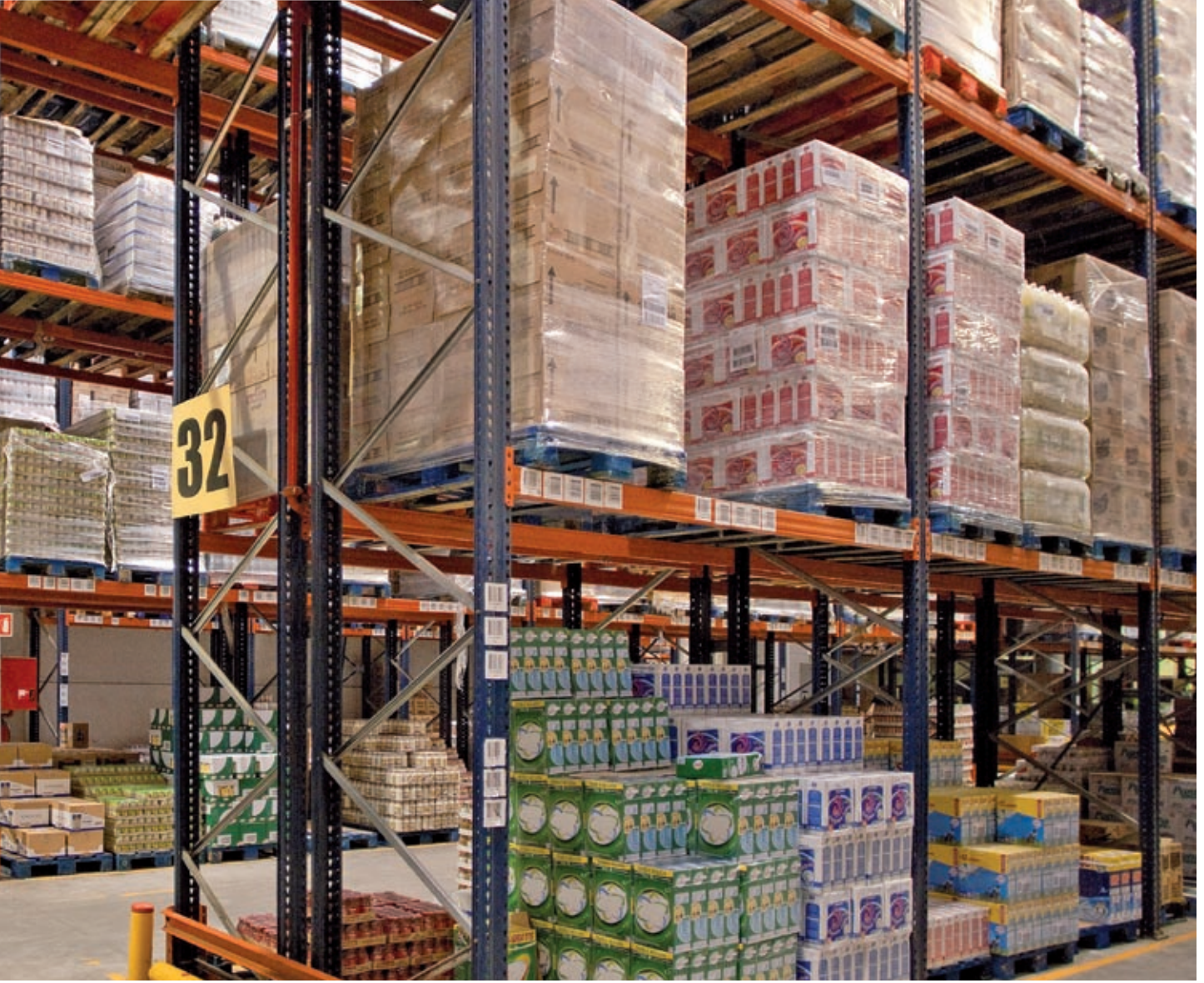
Sırt sırta konvansiyonel palet raflarına 800'lük yönden ve 1.200 mm derinliğine yüklenen paletler.
