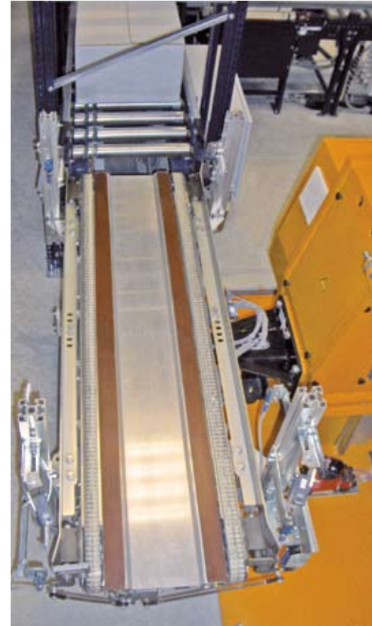
Çatal ve kayışları kombine eden yük alma sistemlerinin (EC) detayları.
