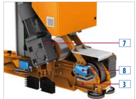
Alt kılavuz kaidesi (3), asansör motoru (7) ve lazerli ölçüm cihazı (8)
