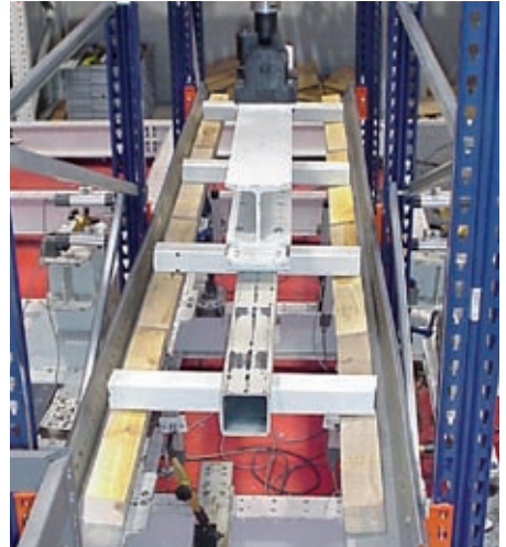
Şekil 4. Drive in palet sistemi için ray testi örneği.
