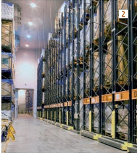
Mobil tabanlar üzerinde bulunan raflarda, orta seviye sipariş rotasyonuna tabi ürünler veya farklı ölçülerdeki paletler depolanır.
