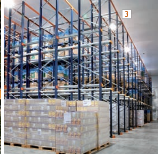
Drive in raflar tek tip ürünlerin uzun süreyle depolanmasına izin verir.
