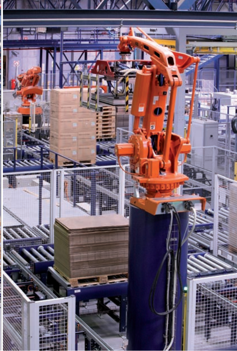
Otomatik sipariş hazırlama sistemi ve robot palet boşaltıcı çalışma şeması.
