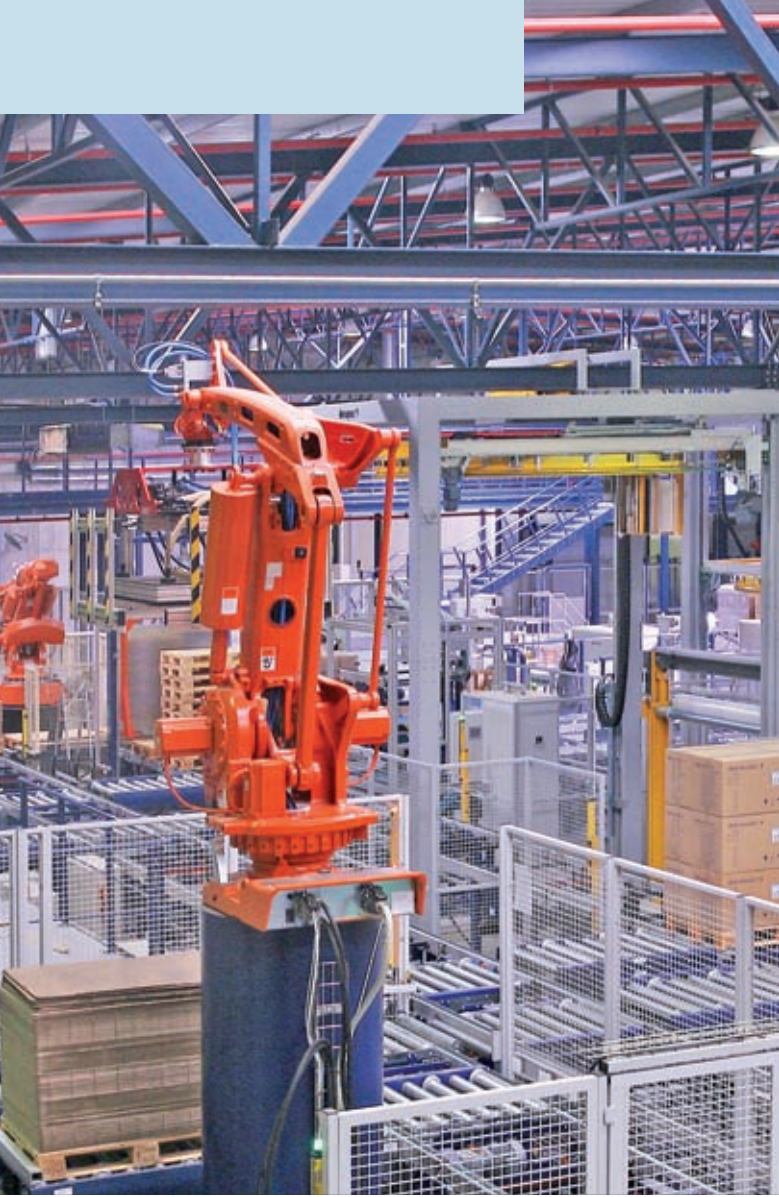
Otomatik sipariş hazırlama sistemi ve robot palet boşaltıcı çalışma şeması.
