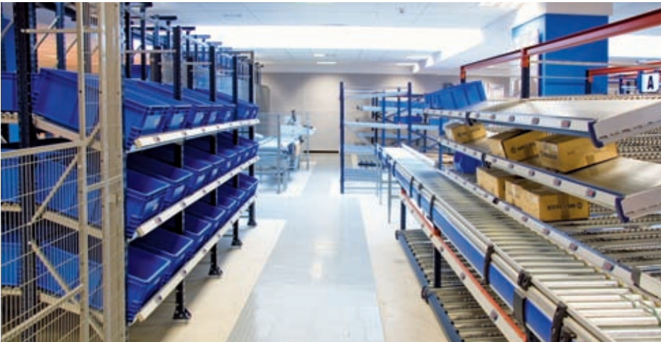
Pick to light sistemli makaralı kayar raf.
